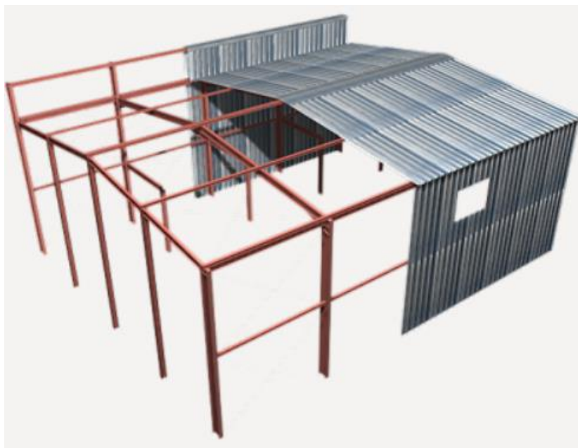
Ilustración 23. Cerramiento Tipo Sándwich
