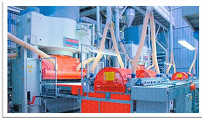
Ilustración 5. Dispositivo RPR para recogida y volteado de baldosas tras prensarlas
