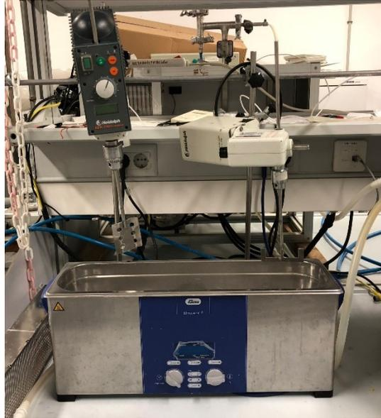
Figura 13. Equipo de extracción sólido-líquido: baño de ultrasonidos y palas rotatorias
