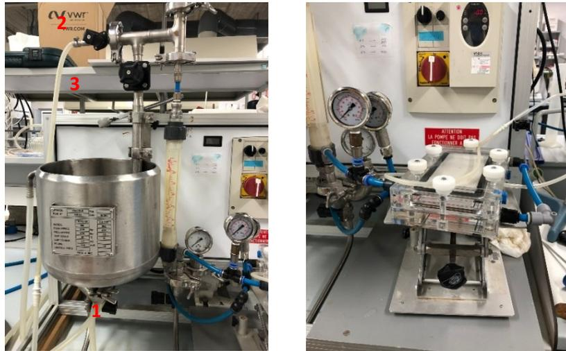
Figura 17. Tanque encamisado de planta de ultrafiltración (Orelis, Francia) (izquierda) y módulo de membranas Rayflow para la planta de ultrafiltración (derecha)
