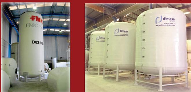
Depósitos verticales de superficie con fondo inferior tori esférico y superior tori esférico, plano o abierto.
