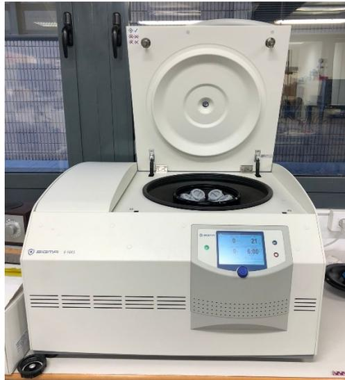
Figura 15. Centrífuga Sigma 6-16KS
