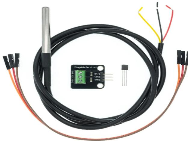
*Imagen 12. Sensor de temperatura del agua DS18B20*
