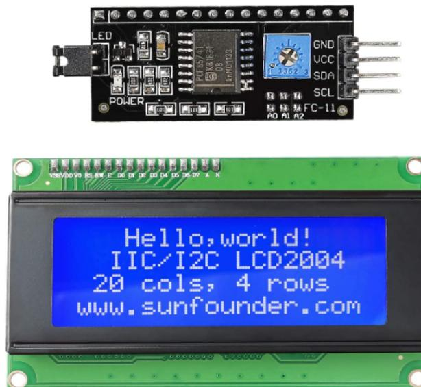
Imagen 13. Pantalla LCD 20x04 + M3dulo I2C
