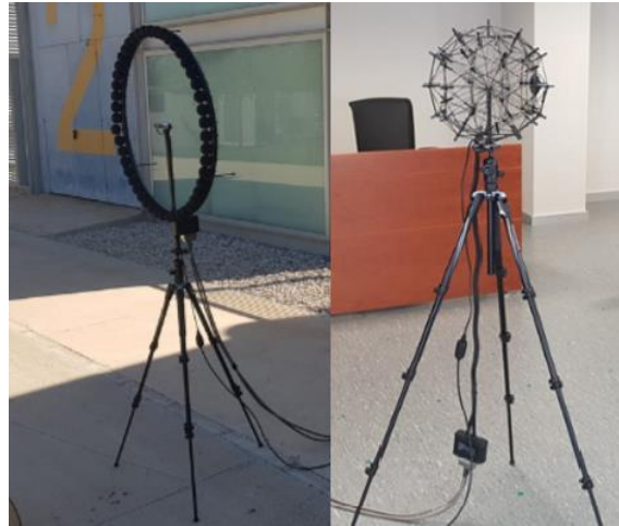
Ilustración 5 Imágenes de las cámaras acústicas empleadas
