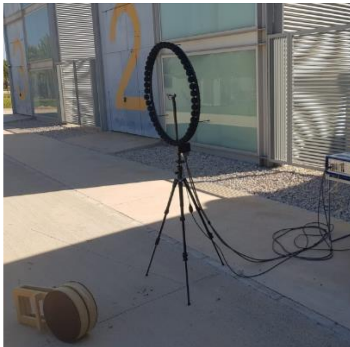
Ilustración 15 Disposición de equipos en el ensayo de omnidireccionalidad
