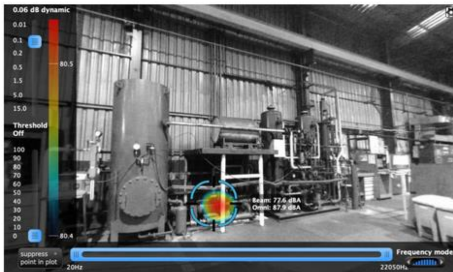
Ilustración 6 Ejemplo de solución obtenida con cámara acústica
