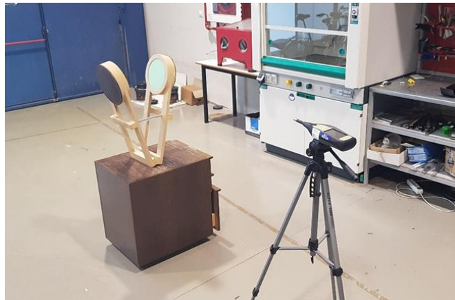
Ilustración 7 Disposición de equipos en el ensayo de repetibilidad
