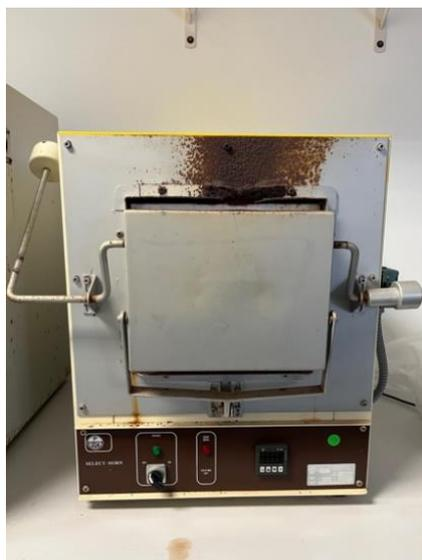
*Figura 13. Muestra dentro de la Mufla para eliminar la materia orgánica.*
