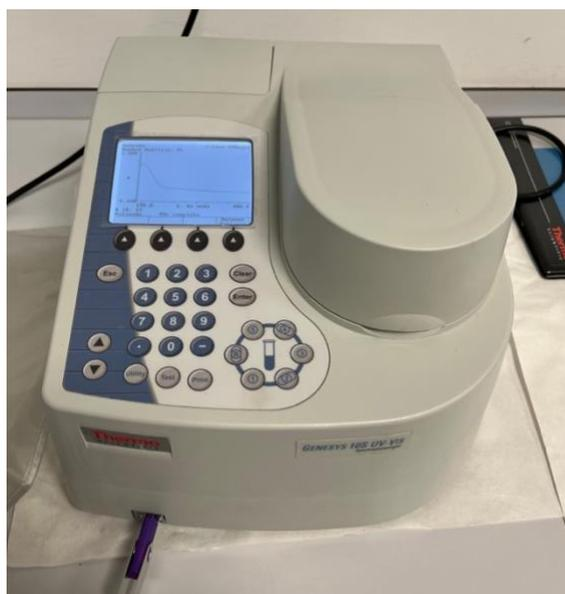
*Figura 12. Lectura de las absorbancias mediante espectrofotómetro UV-Visible.*
