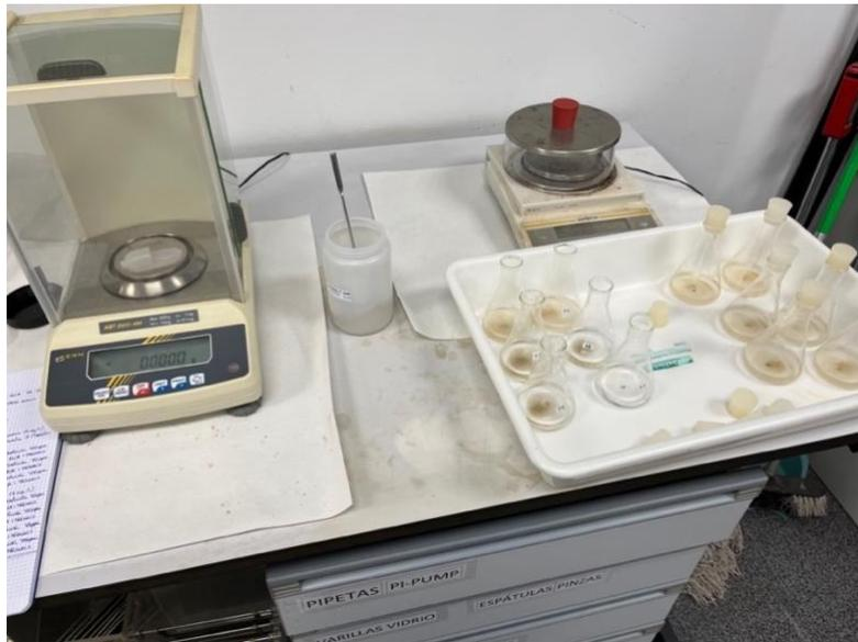
*Figura 10. Pesada sedimento para cada muestra.*
