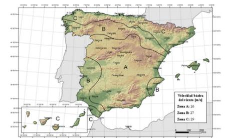
Valencia queda en la zona A, que posee una  $v_b = 26$  m/s, lo que le corresponde una presión dinámica de  $q_b = 0,42$  kN/m<sup>2</sup>.
