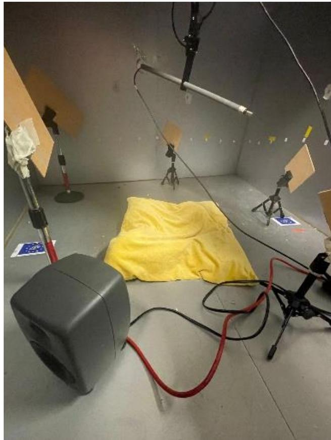
**Figura 19. Ensayo del cojín en la cámara reverberante**
