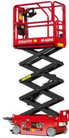
Imagen 32. Plataforma elevadora de trabajo. (Magni Telescopic Handlers SRL, 2023)
