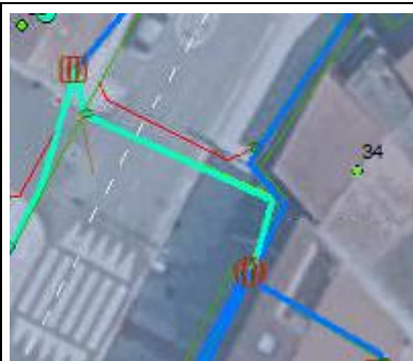
Figura 65. Cable canalizado desde la minicau de la segunda RD.
