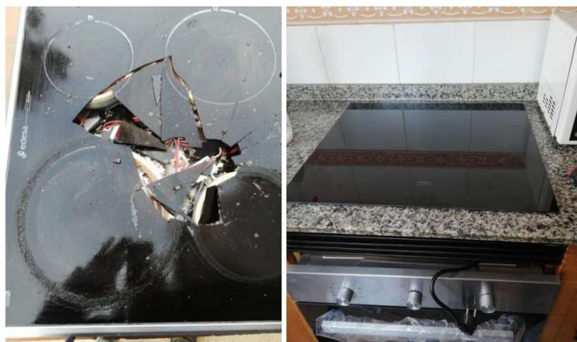
Imagen 37: Rotura de vitrocerámica/fuente propia
