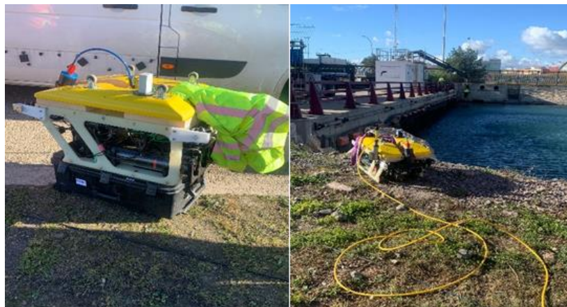
Figura 17 Apariencia de dron acuático para batimetrías Fuente: Propia
