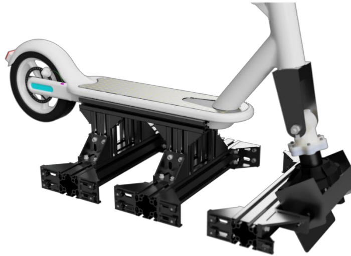
Figura 72 Renderizado de la estructura diseñada para sujetar el motor a la plataforma
