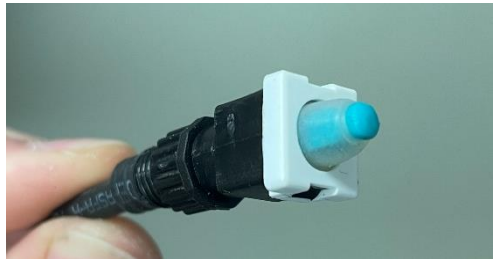
Figura 38 Sensor de tipo pulsador implementado en el freno
