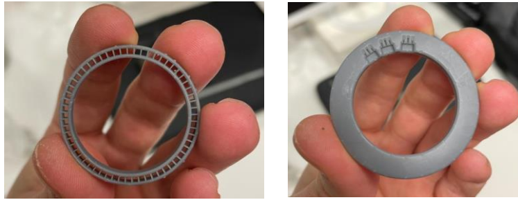
Figura 52 Resultado de la impresión 3D en resina
