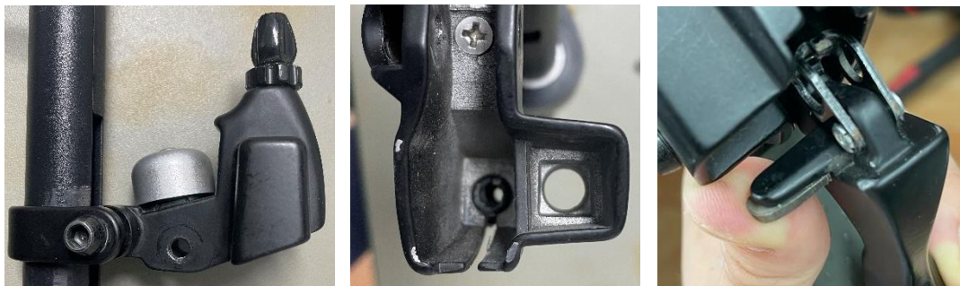
Figura 39 Receptáculo y elemento accionador del sensor de detección de frenada
