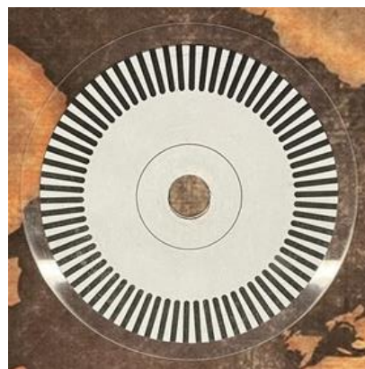
Figura 26 Plantilla creada y adherida a disco compacto con el fin de testear el circuito de adquisición propuesto
