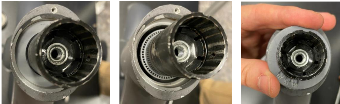
Figura 53 Colocación de las piezas diseñadas en 3D en el interior del chasis del patinete
