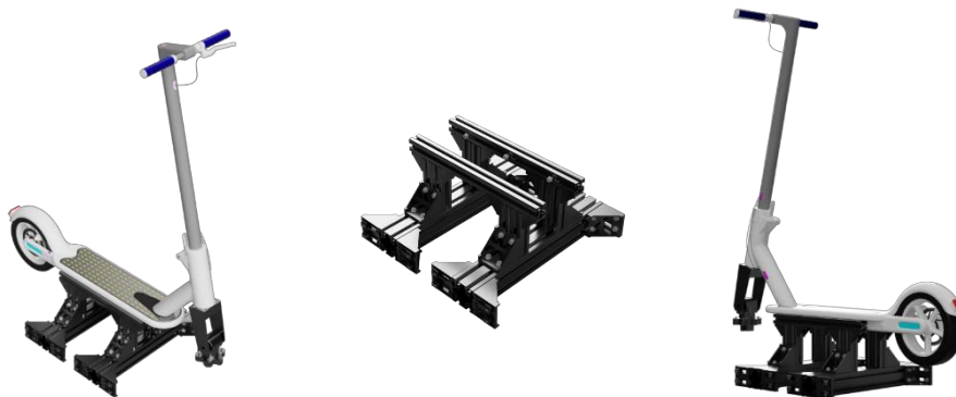
Figura 62 Renderizado 3D en detalle del elemento de sujeción del patinete eléctrico
