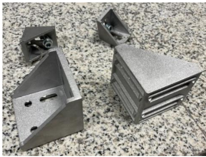
Figura 5 Escuadras utilizadas en el montaje de la plataforma de sujeción
