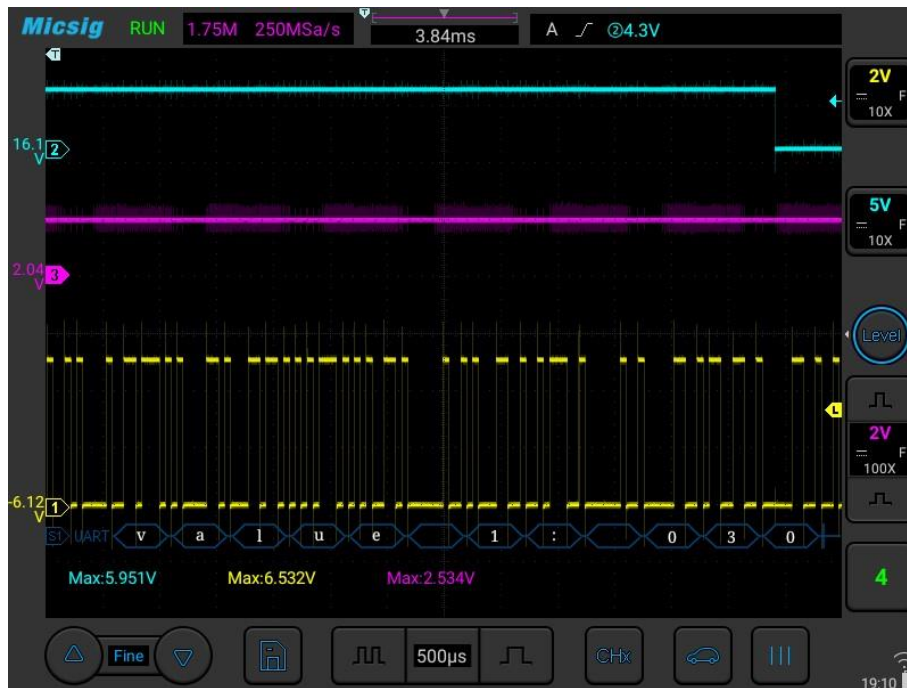
Figura 140 Captura de datos del bus de comunicaciones UART en la placa de adquisición, acelerador a un poco más de un cuarto de su recorrido
