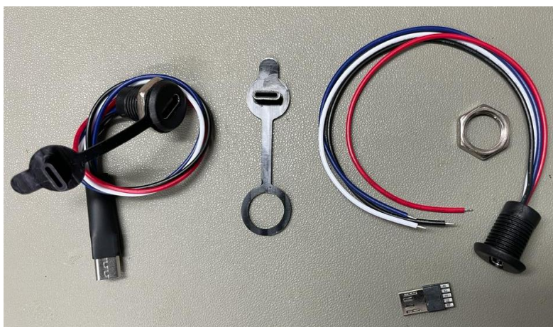
Figura 143 Elementos que componen el adaptador micro USB a USB C de la plataforma
