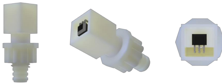
Figura 65 Renderizado 3D del sensor de adquisición de frenado diseñado
