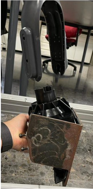
Figura 69 Representación visual de la colocación del motor en relación con la horquilla del patinete
