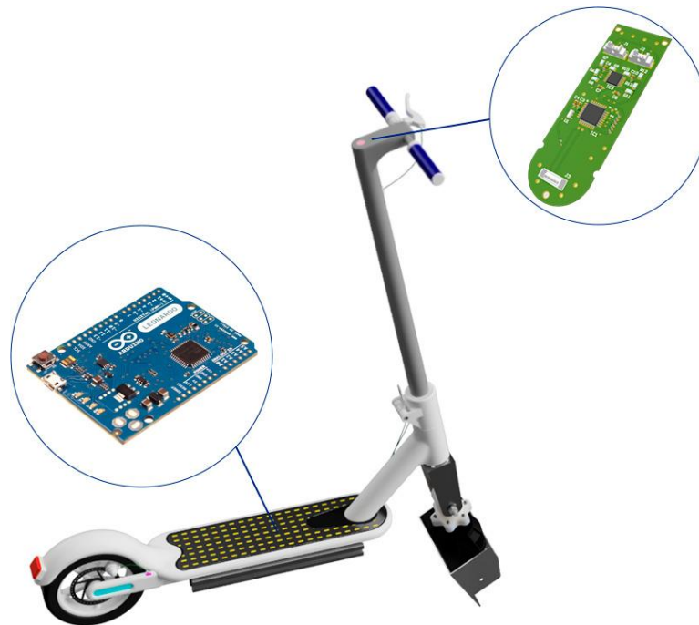
Figura 75 Esquema visual de la disposición de microcontroladores en el patinete eléctrico
