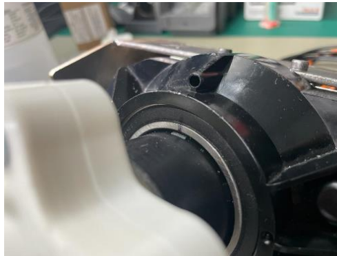
Figura 127 Marca realizada al eje de giro para determinar el ángulo de giro por pulso generado en el encoder
