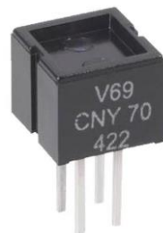
Figura 11 Optoacoplador modelo CNY70 del fabricante VISHAY, imagen obtenida de www.geekfactory.mx
