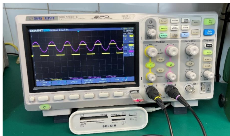
Figura 29 Análisis de respuesta del circuito de adaptación de señal del sensor óptico. Señal generada por el sensor (morado). Salida digital generada por el circuito (amarillo).
