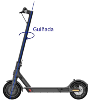
Figura 22 Correspondencia del eje de giro del manillar con el eje de guiñada
