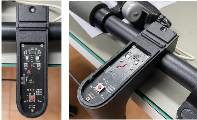
Figura 138 Resultado del montaje en el manillar de la placa de adquisición
