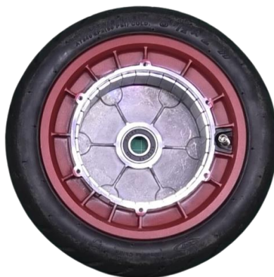
Figura 33 Conjunto de 30 imanes dispuesto a lo largo del diámetro interior de la rueda del Xiaomi mi 365. Imagen tomada del canal de YouTube de Vortecks https://www.youtube.com/watch?v=SNU9H51hpaA&ab_channel=Vortecks
