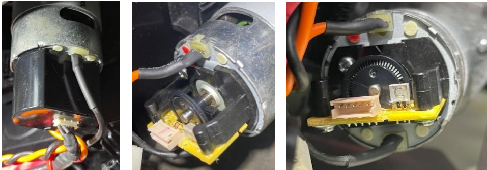
Figura 125 Capturas del encoder que incorpora el Logitech G27
