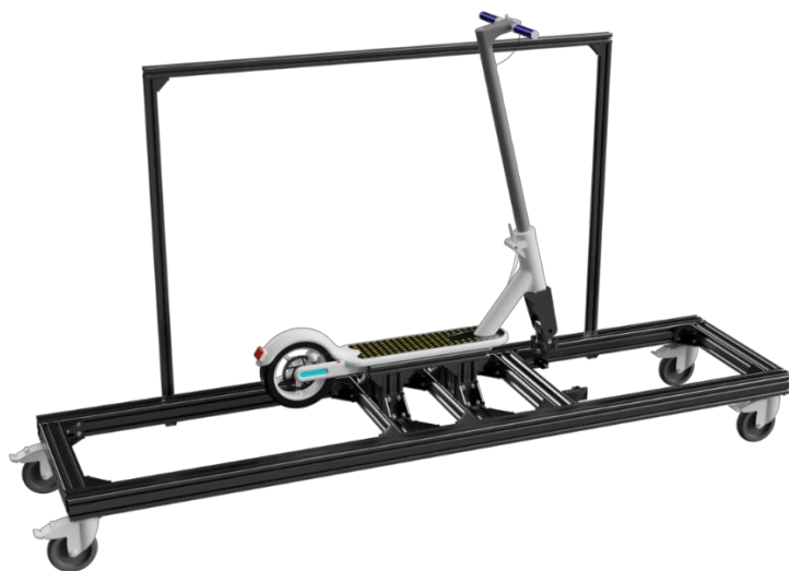
Figura 61 Renderizado 3D global del elemento de sujeción del patinete eléctrico
