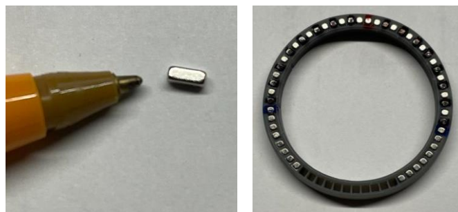
Figura 54 Fotografía tomada del imán utilizado y su colocación en el anillo diseñado a este fin
