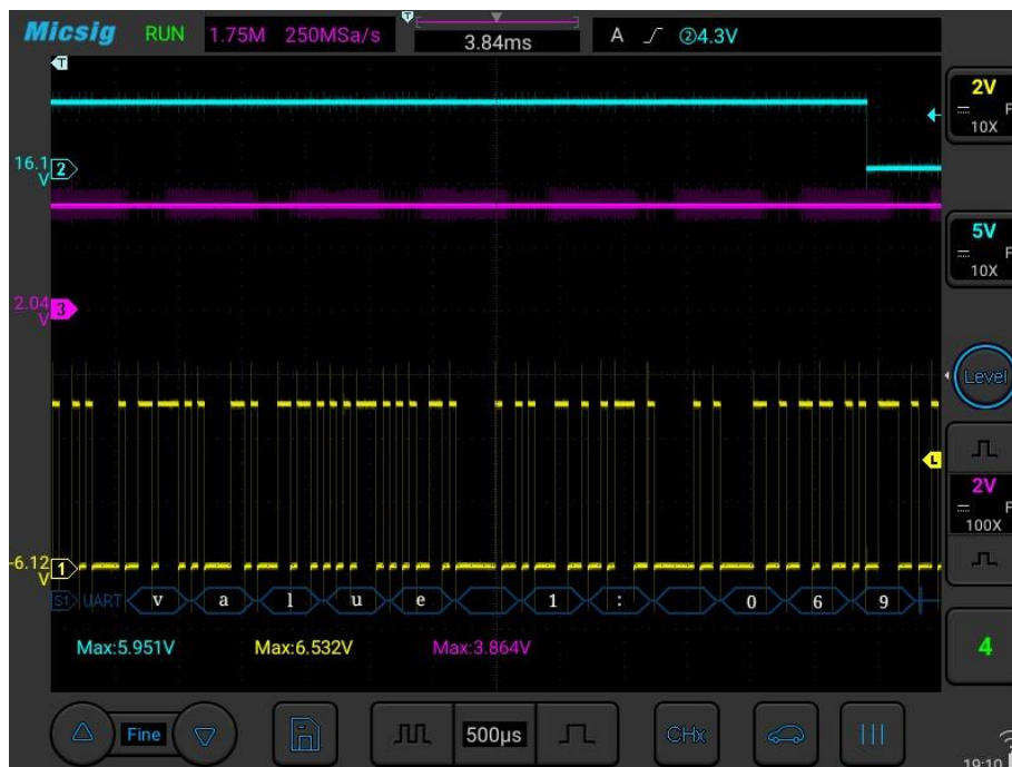
Figura 141 Captura de datos del bus de comunicaciones UART en la placa de adquisición, acelerador al máximo
