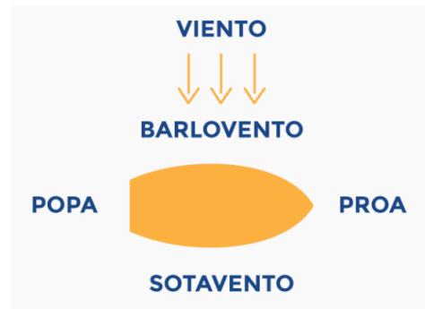
Figura 7: Definición del viento sobre una embarcación en el entorno náutico.
