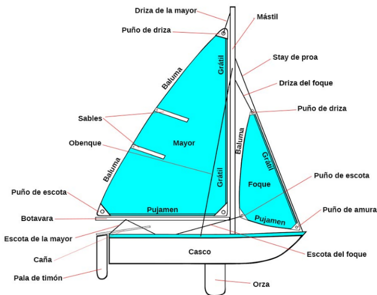
Figura 11: Definición de los componentes de una embarcación de vela.
