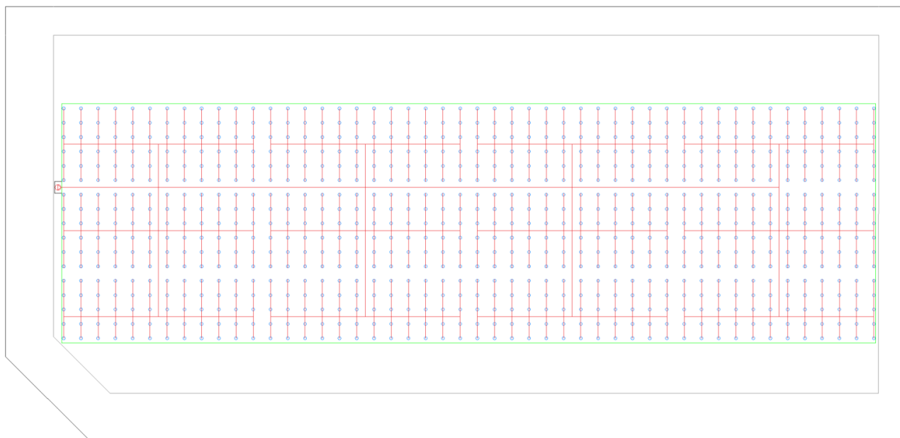
Ilustración 32. Distribución de tuberías de rociadores automáticos en la nave de código 12b.
