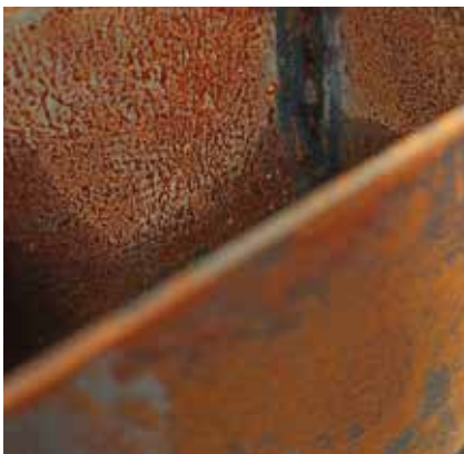
20. Detalle de oxidación en la pieza Rojo y blanco
