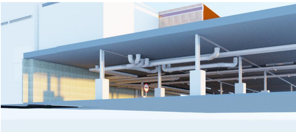
Ilustración 76 Imagen 2 Renderizado tuberías Fuente: Elaboración Propia
