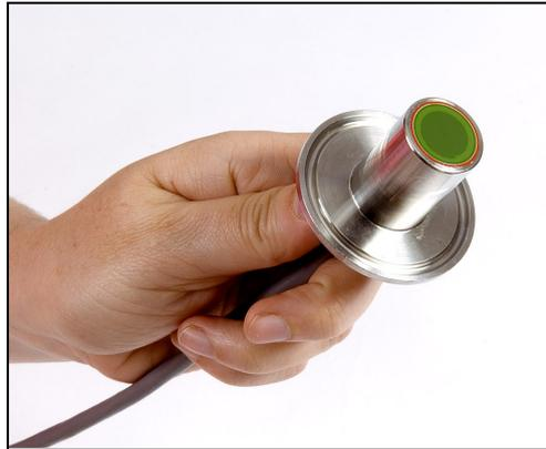
Figura 20. Sensor de Efusividad Térmica.
