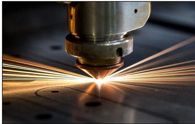
Figura 86. Máquina de Corte Láser en Acción.
