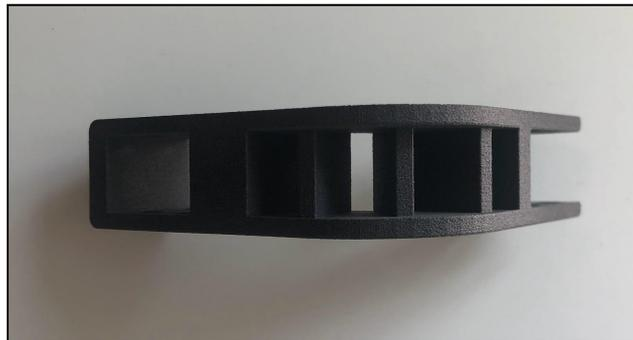
Figura 94. Arco Estructural Fabricado por SLS.
