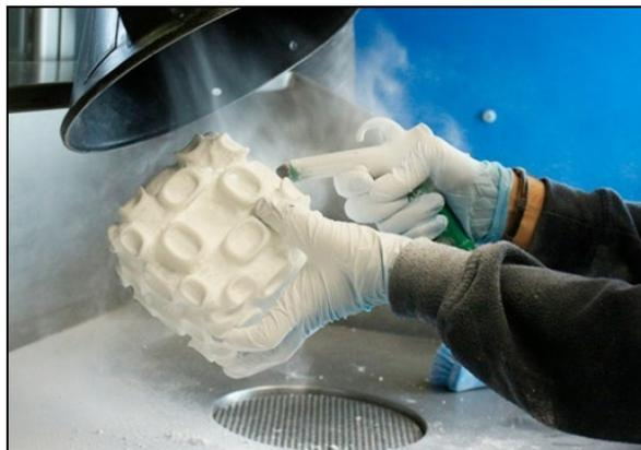
Figura 85. Limpieza de una Pieza Fabricada por SLS.
