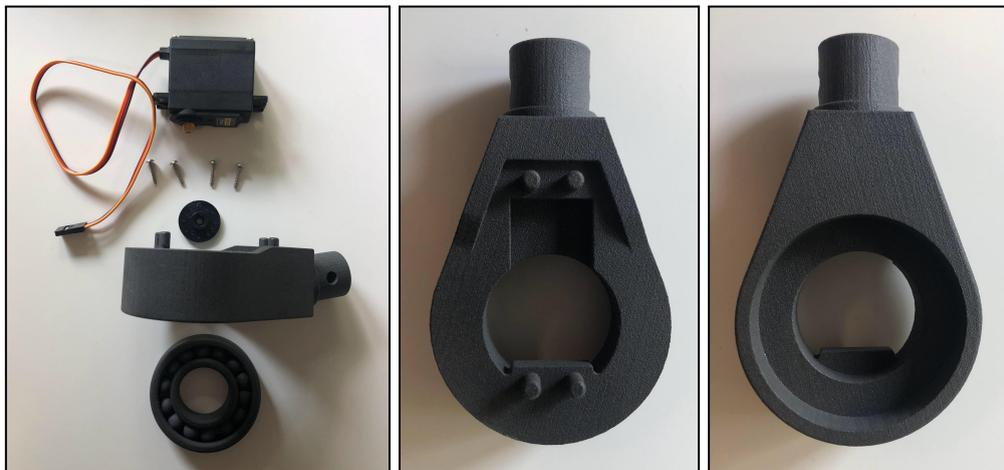
Figuras 101(a) , 101(b) y 101(c). Despiece Ensamblaje Servomotor y Acoplamiento Rueda.
