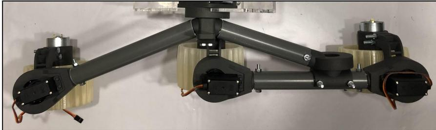
Figura 111. Ensamblaje Rocker-Bogie Completo.
