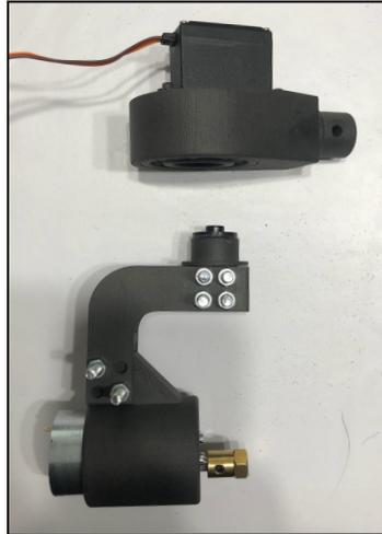
Figura 102. Despiece Ensamblajes Estructurales de la Rueda y Motores.
