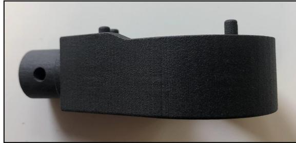
Figura 109. Acoplamiento Rueda Trasera.
