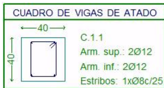
Imagen 19. Vigas de atado.
