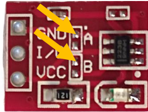
Figura 38. Puentes A y B
