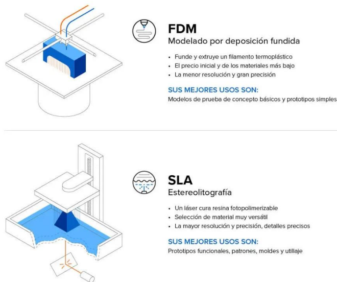
Figura 58. Tecnologías de impresión 3D para plásticos [70]
