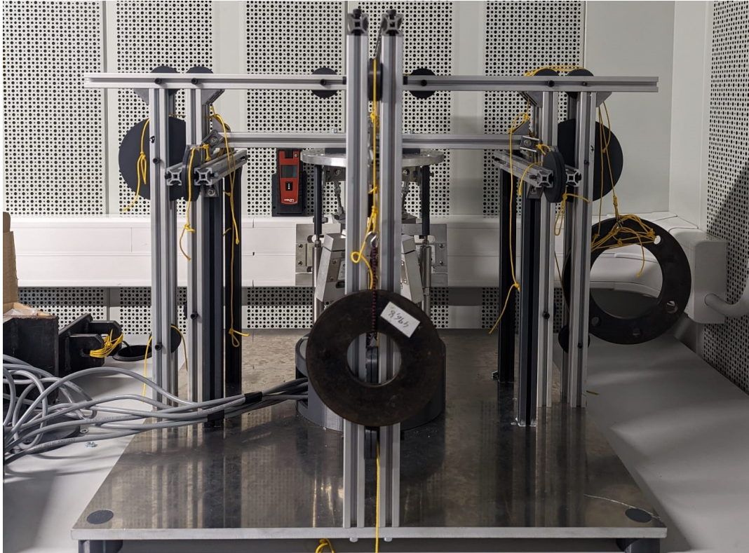
Figura 6.7: Calibración de la balanza: Estado de carga 1.
