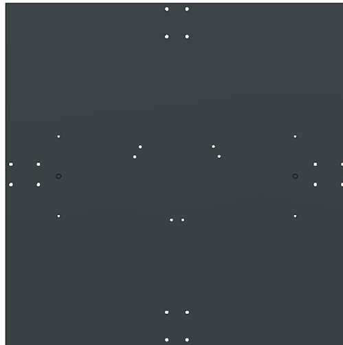
Figura 6.2: Montaje sistema de calibración balanza túnel de viento: Placa de aluminio.
