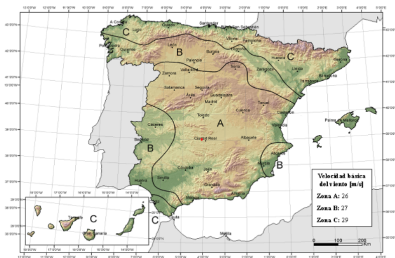
Figura D.1 Valor básico de la velocidad del viento, v_b Imagen 15. Figura D1 del CTE DB SE-AE.
