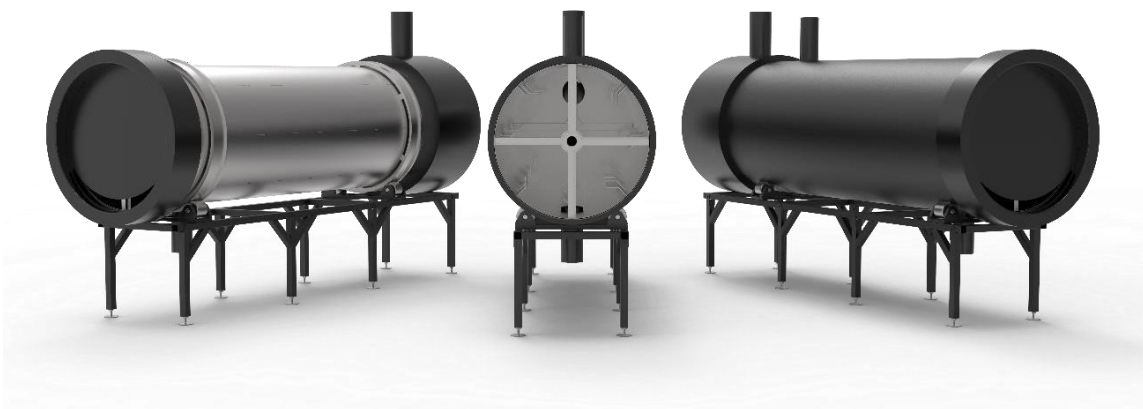
Ilustración 100: Renderizado del trómel sin chasis 2. Fuente: Elaboración propia (2023)
