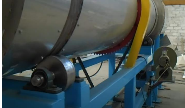
Ilustración 43: Sistema de transmisión de movimiento por cadena. Fuente: https://www.youtube.com/watch?v=kB0sHCX6UOU (Youtube, 2023)
