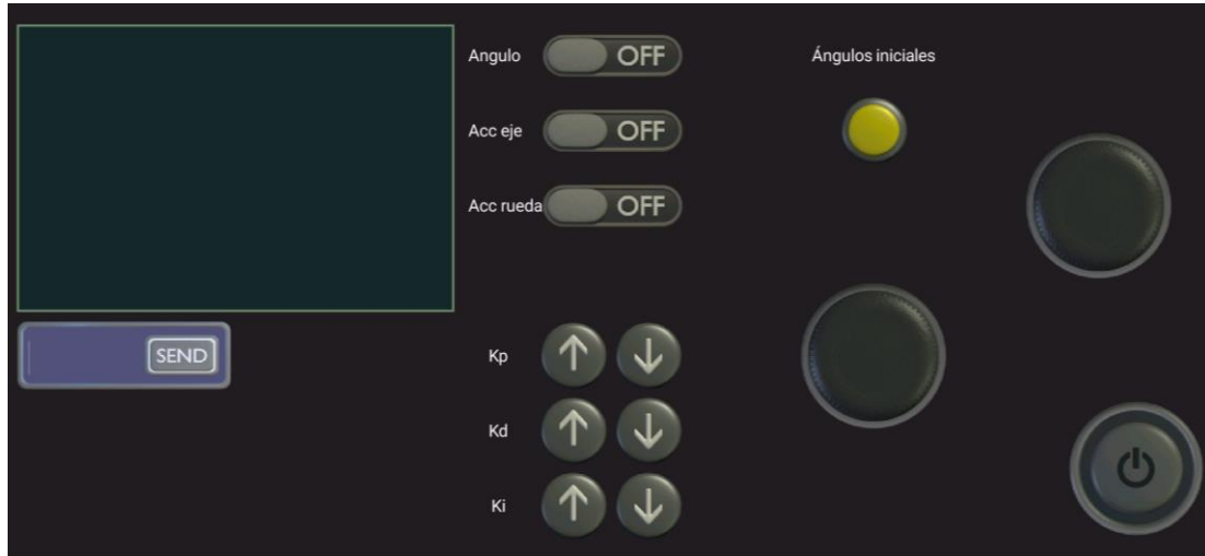
Figura 5.18.- Panel de control de la aplicación móvil
