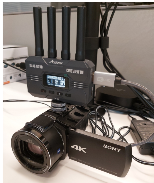
Figura 4.9: Càmera Sony Handycam FDR-AX43 amb el transmissor de vídeo.
