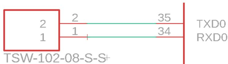
Figura 10: Conexión cabecera con los pines Rx y Tx
