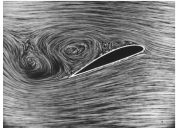
(b) Flujo desprendido a alto ángulo de ataque.
