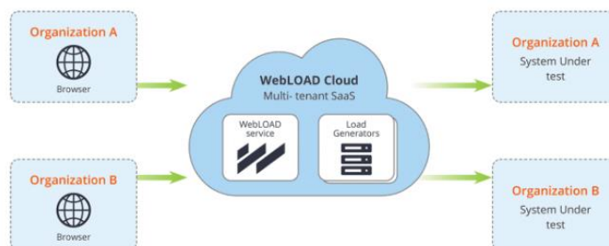
Figura 8. Esquema de cómo trabaja WebLOAD [25].
