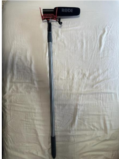
Ilustración 12 Resultado final del micrófono con pértiga
