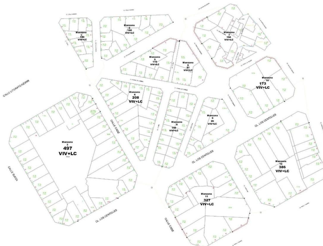
**Figura 5. Plano replanteado con viviendas, canalizado, saltos y bajantes. Las viviendas se ven reflejadas en el interior de las parcelas con la simbología “X Viv. + X Loc.”. El canalizado se representa con una línea discontinua mientras que los saltos con una línea de color azul. La bajantes se ven reflejadas en donde corresponde con el número de plantas que hay.**
