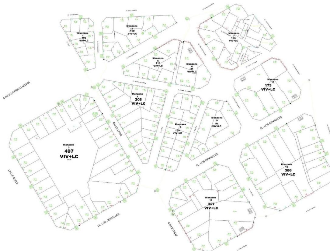
**Figura 11. Plano con las cajas colocadas y sus respectivas cajas de distribución óptica. Las cajas de exterior (CTO) se representan mediante cuadrados de contorno verde en el contorno de las manzanas, y las de interior (CMI) mediante recuadros de contorno negro en el interior de edificios.**
