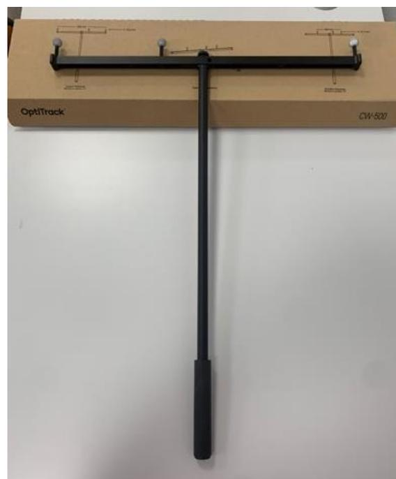
Ilustración 5. Bastón de calibración CW-500.
