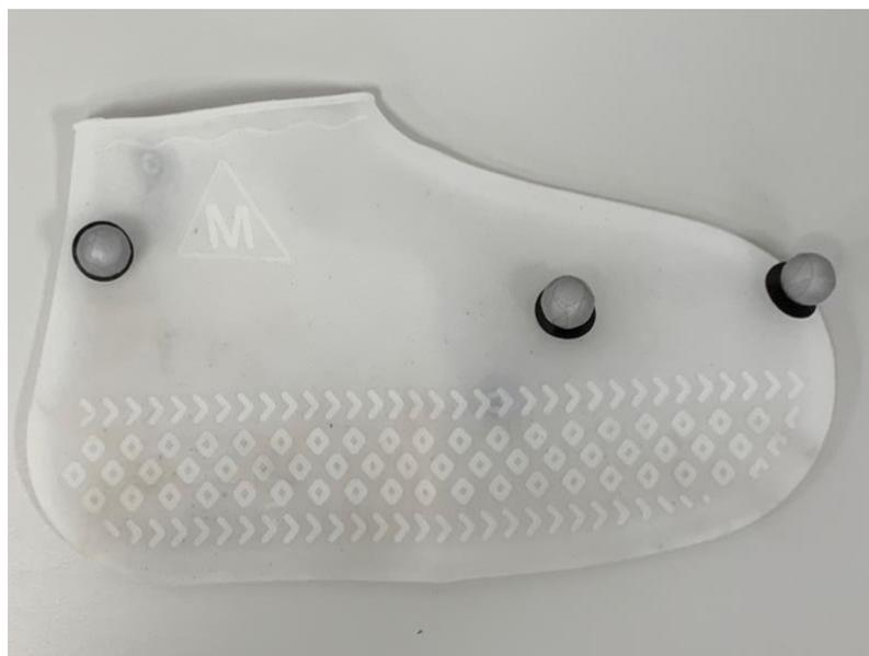
Ilustración 15. Cubre calzado con sensores.
