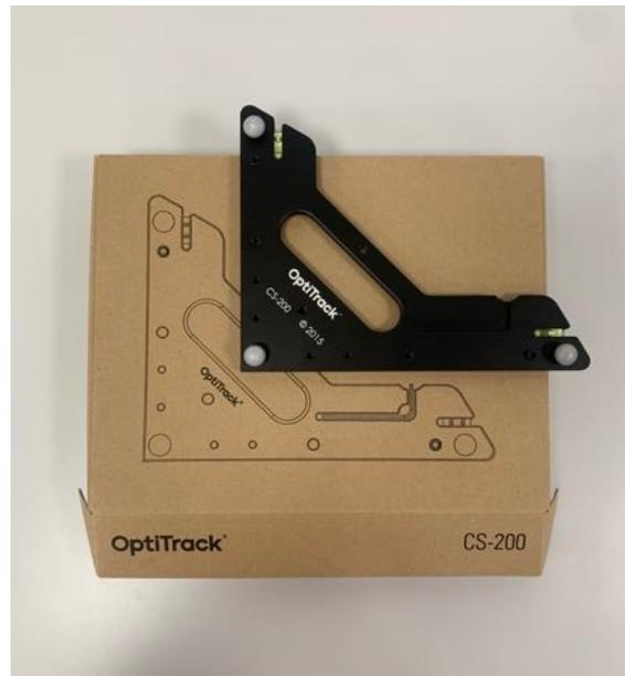
Ilustración 4. Escuadra de calibración CS-200.
