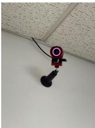
Ilustración 8. Cámara OptiTrack Flex 13.
