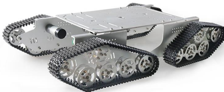
Figura 3.1.1: Chasis de aluminio el sistema móvil
