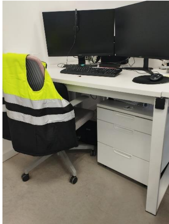
Figura 17. Espacio libre bajo mesa insuficiente, aproximadamente 65cm de ancho.
