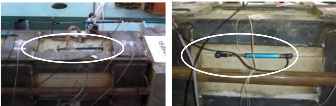
Figura 47. Colocación de los captadores en cada una de las secciones del soporte.
