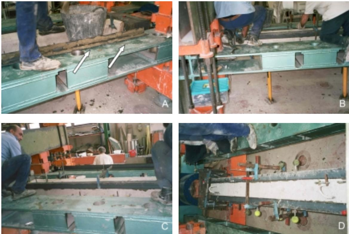
*Figura 35. Secuencia de colocación de los angulares metálicos.*
