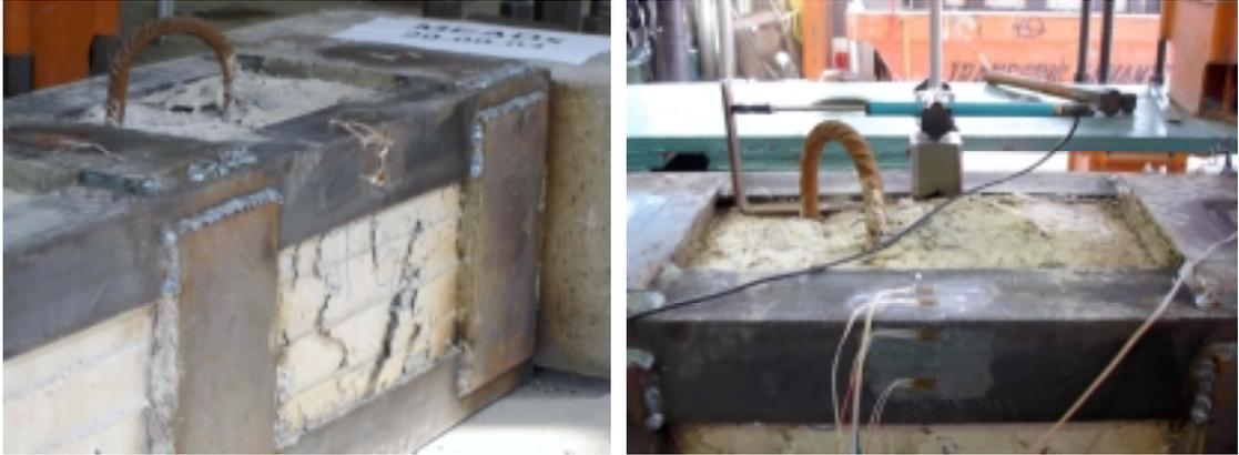
*Figura 88. Rotura del espécimen MEADx simultáneamente por la sección 1 y 4.*
