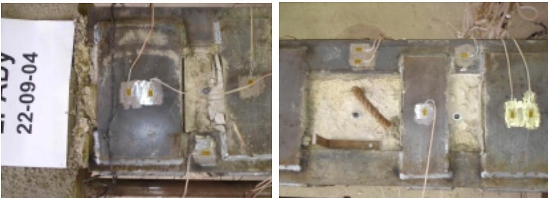
*Figura 100. Rotura del soporte PADy por las secciones 1 y 6 simultáneamente.*
