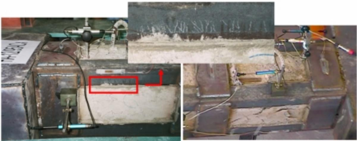
*Figura 73. Rotura del espécimen ACx en las secciones 4 y 1. Detalle del acero del angular estriado debido a las altas tensiones soportadas.*
