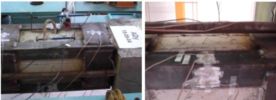
*Figura 69. Rotura del espécimen ADy por las secciones 1 y 4.*
