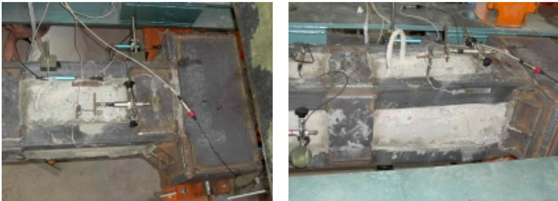
*Figura 79. Rotura del espécimen BDy por la sección 1.*
