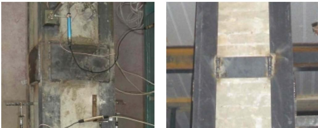
*Figura 33. Distintos modos de colocar las presillas: sobre en angular o a tope.*
