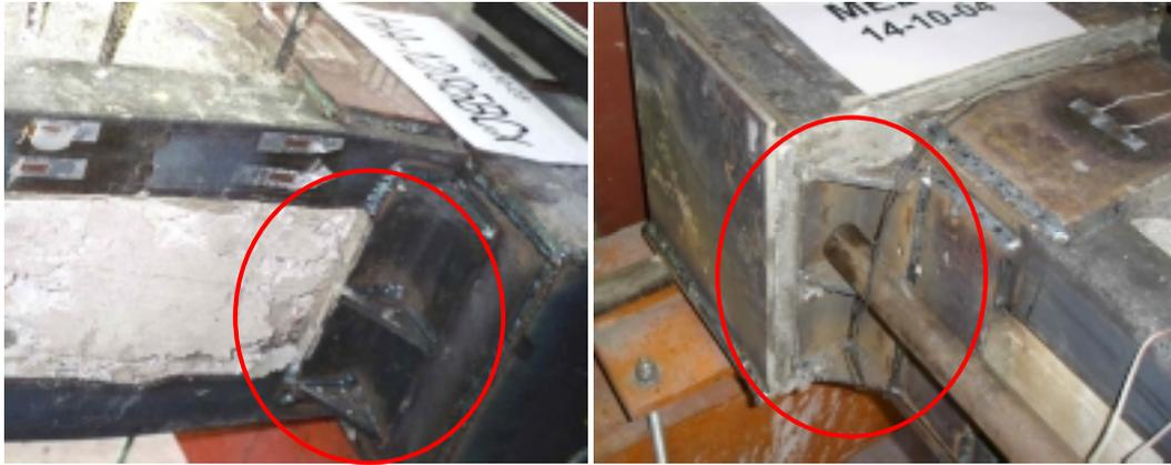
*Figura 31. Detalle del capitel y su situación en la primera y segunda fase de ensayos.*
