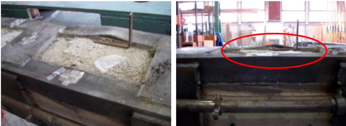
*Figura 110. Rotura del soporte PBDy por las secciones 3 y 4.*
