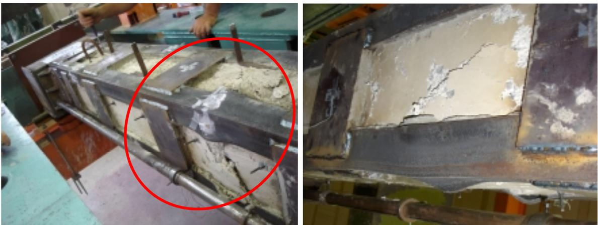
*Figura 115. Rotura del soporte PBCy por la sección 3.*
