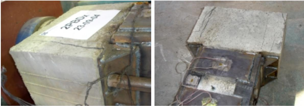
*Figura 109. Rotura de las cabezas del soporte PBDx*
