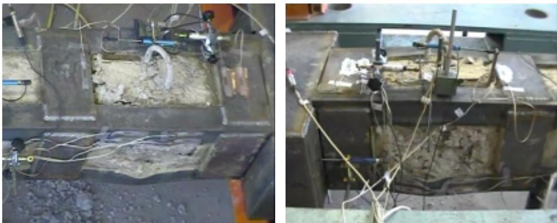
*Figura 74. Rotura del espécimen ACy en la sección 1.*
