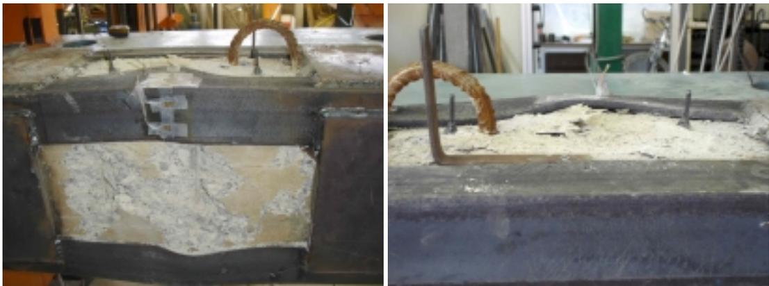
*Figura 94. Rotura del soporte MEBDy por la sección 1.*
