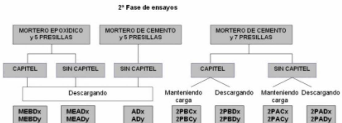
Figura 37. Segunda fase de Ensayos.
