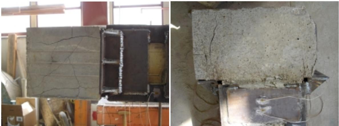
*Figura 114. Rotura del soporte PBCx por las cabezas.*
