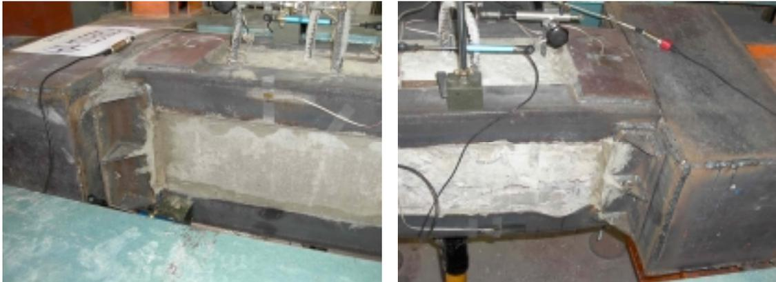
*Figura 78. Especimen BDx antes del ensayo y rotura por la sección 1.*
