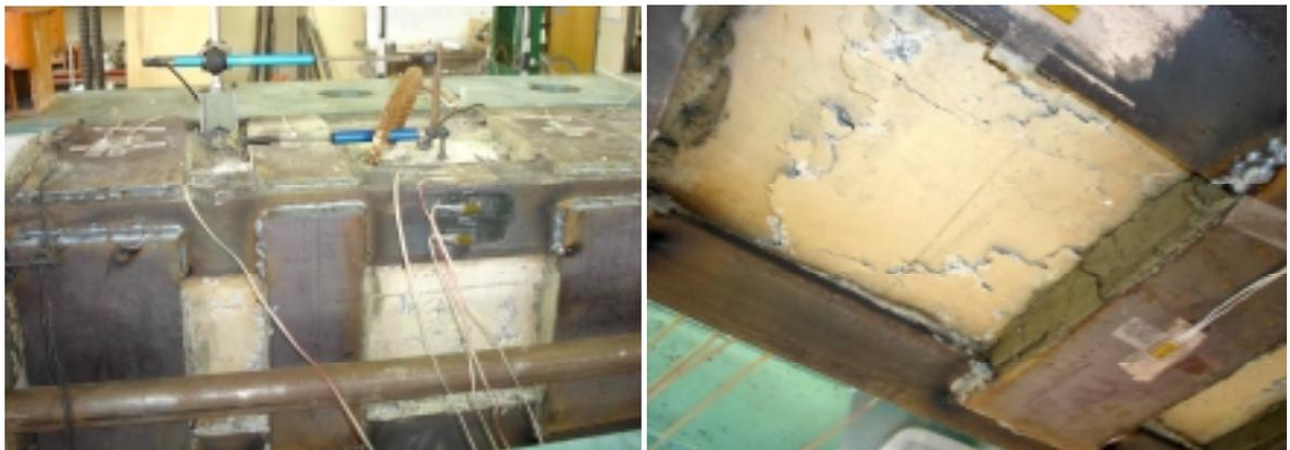
*Figura 105. Rotura del soporte PACy por las secciones 5-6.*
