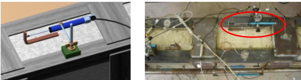
Figura 132. Esquema y fotografía de la situación de los LVDT.
