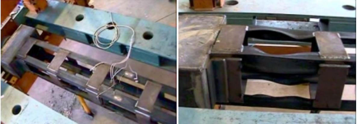
Figura 27. Jaula formada por el acero del refuerzo en el ensayo para determinar su módulo de elasticidad.
