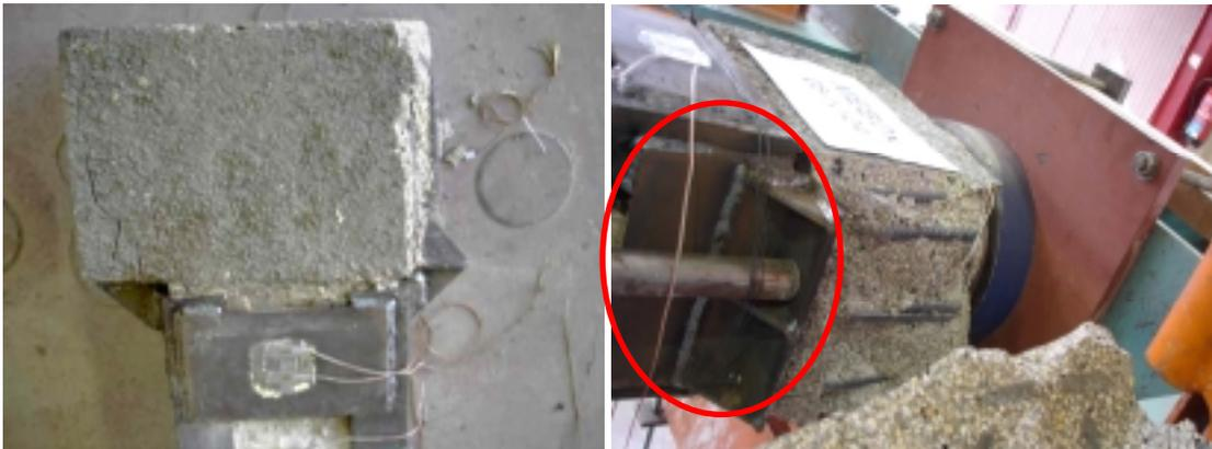
*Figura 93. Rotura de las cabezas del soporte MEBDx, antes de llegar al axil último del tramo de pilar reforzado.*
