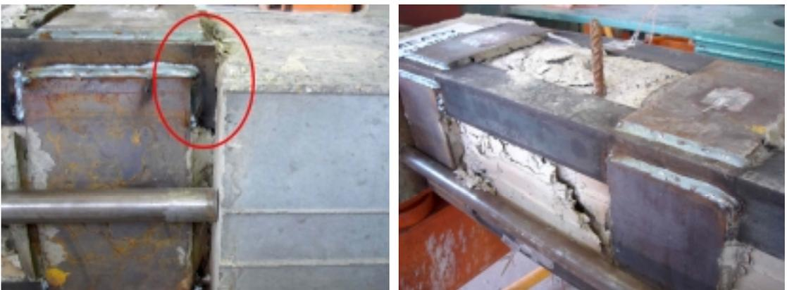
*Figura 89. Rotura del espécimen MEADy simultáneamente por la sección 1 y 4.*
