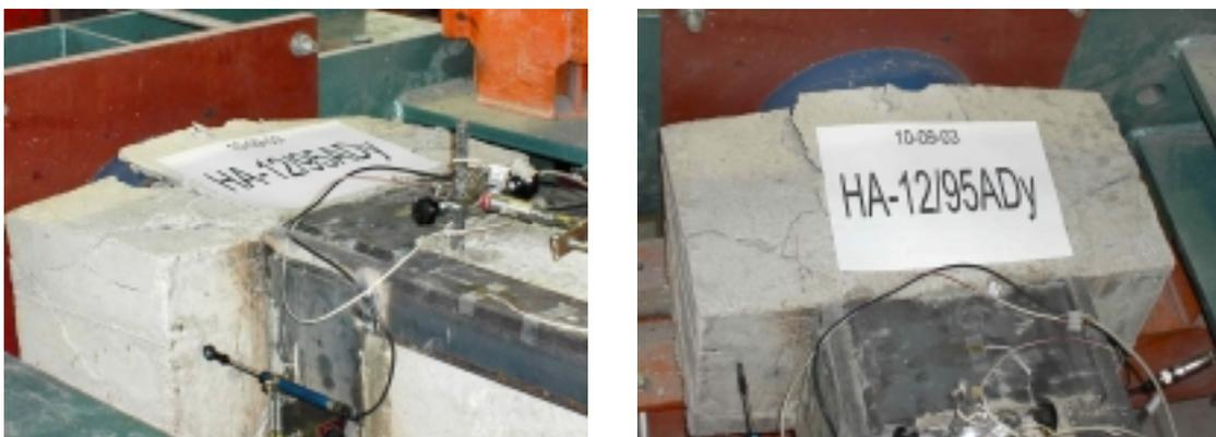
*Figura 64. Rotura del espécimen ADy por una de las cabezas.*
