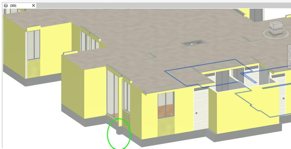
**Ilustración 9** Cimentación excedente no considerada en planos de arquitectura Visualización 3D Fuente Elaboración propia
