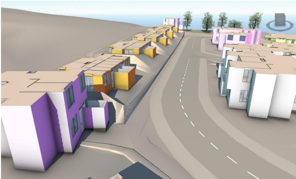
**Ilustración 16 Nivelación exterior de viviendas posterior a la ejecución de movimiento de tierras Fuente Elaboración propia**
