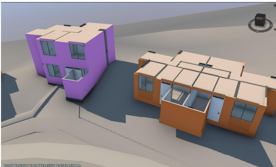
**Ilustración 11** Viviendas tipo Aleli y tipo Texao, los ductos sanitarios se encuentran descubiertos, vulnerables a lluvias Fuente Elaboración propia
