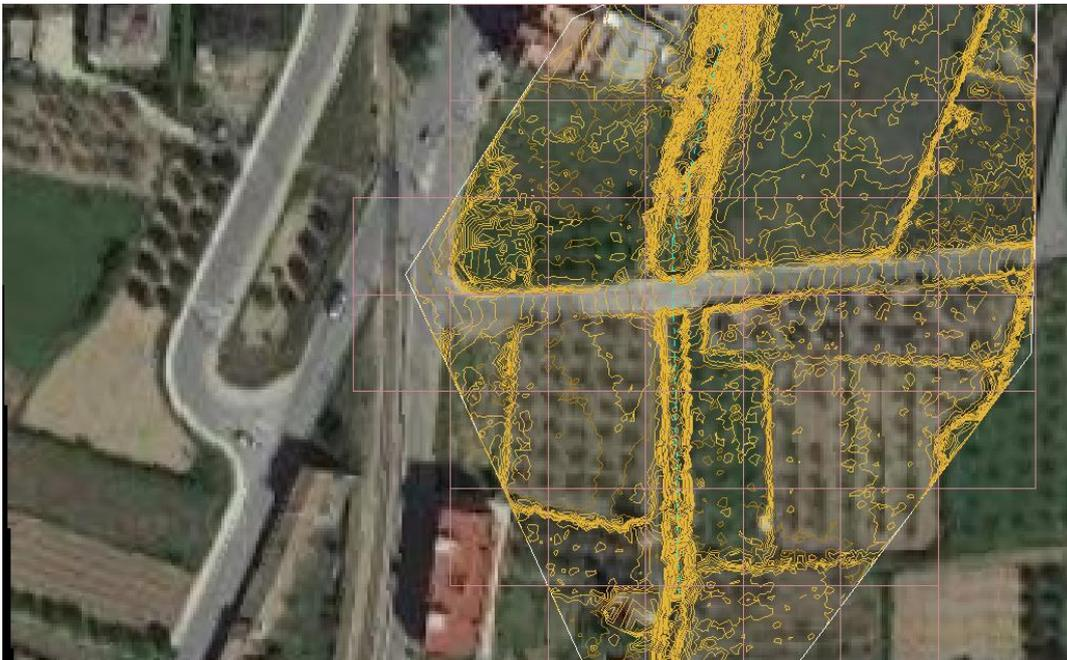
Figura 31. Detalle líneas de nivel y eje del cauce. (Fuente: ISTRAM).
