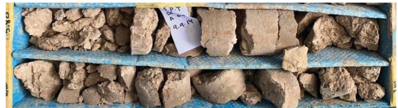
Figura 2 Testigo de limos arcillosos con aspecto margosos del nivel I. Fuente: PBC Viaducto del Quisi
