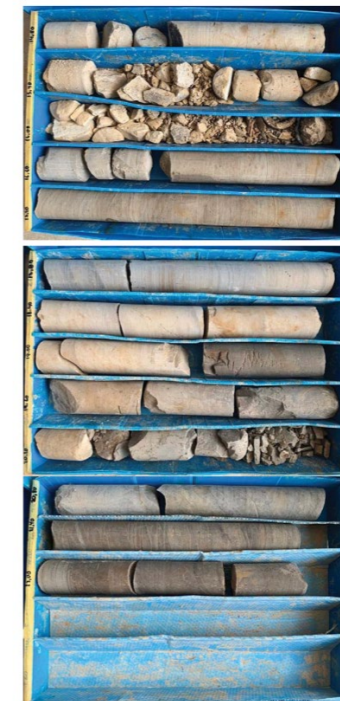
Figura 6. Caja de testigo correspondiente al sondeo de la pila 5. Fuente: PBC Viaducto del Quisi..
