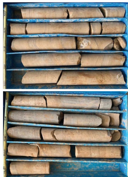
Figura 5. Caja de testigo correspondiente al sondeo de la pila 4. Fuente: PBC Viaducto del Quisi..
