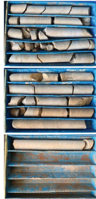
Figura 4. Caja de testigo correspondiente al sondeo de la pila 7. Fuente: PBC Viaducto del Quisi.
