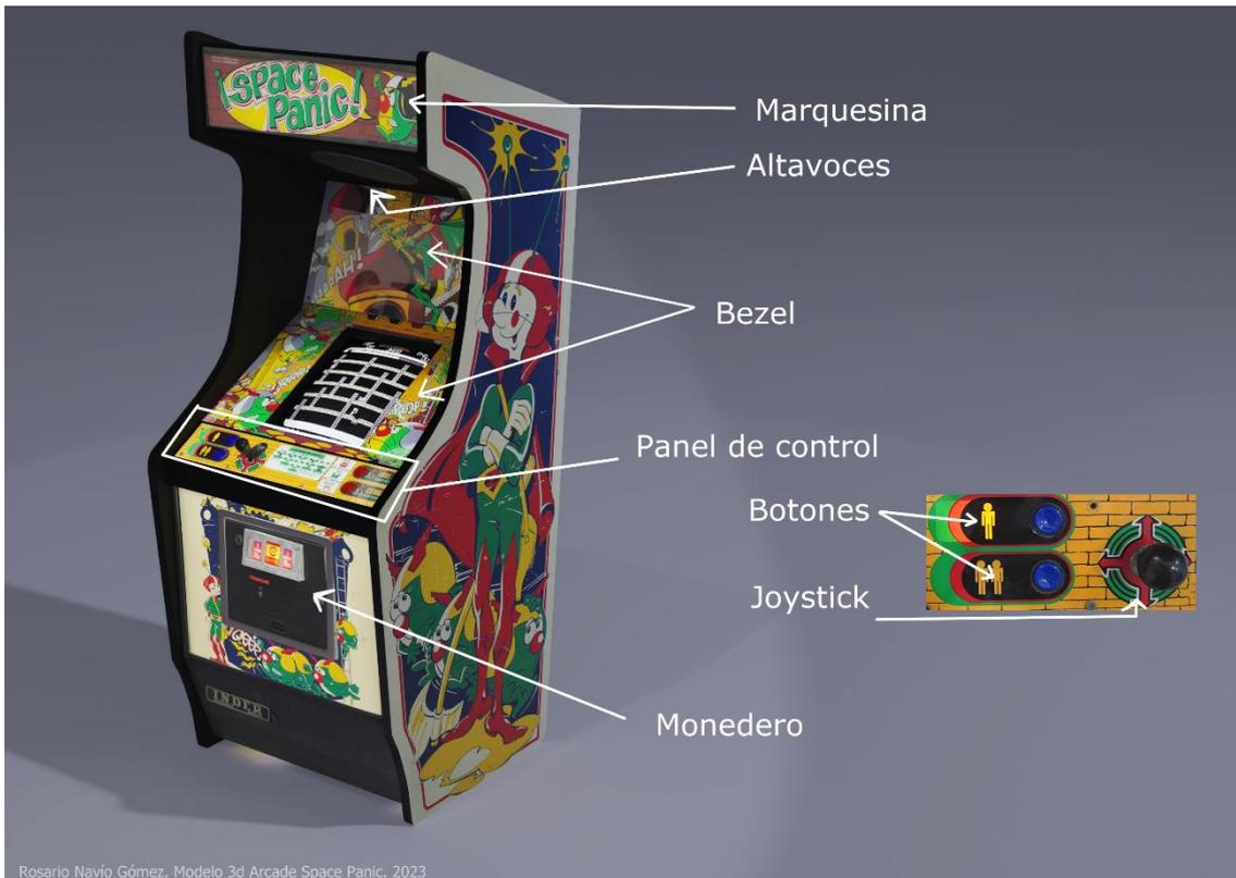
Imagen 8 Modelo 3D de "Space Panic" señalando las partes características de la zona frontal. Creación personal.
