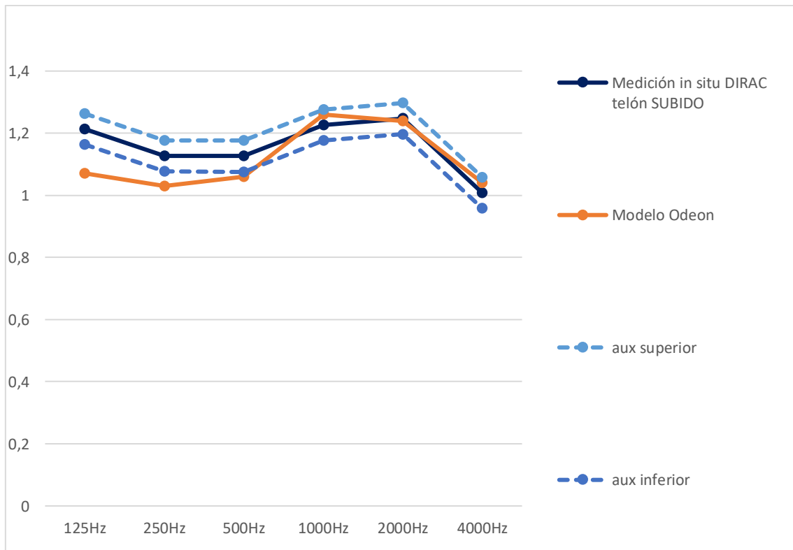
Figura 204. Comparativa TR 30 , medición "in situ" con telón subido y modelización inicial con boca de escena abierta
