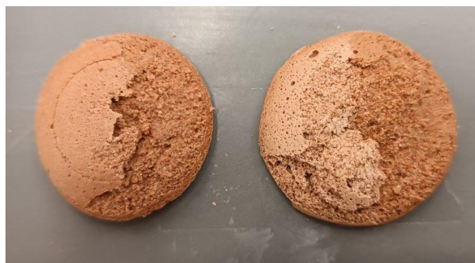
Figura 62 Prueba de humectación con disolvente.
