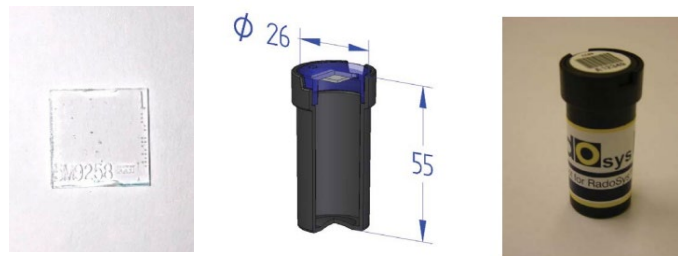
Figura 3.4 RadoMeter 2000 con la cámara de difusión y el cristal de CR39.
