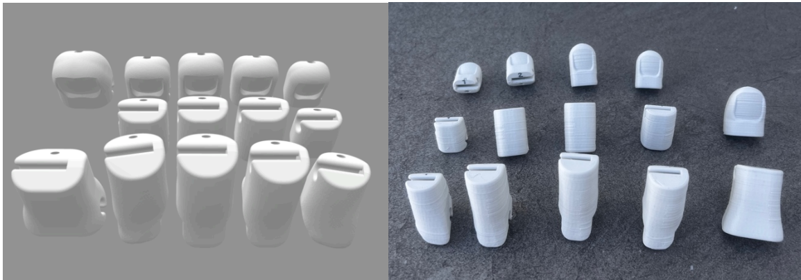
Figura 15 y 16. Izquierda; Vista del archivo STL proporcionado por P4H Bionics de los dedos de la mano izquierda. Derecha; Resultado de la impresión de los dedos.
