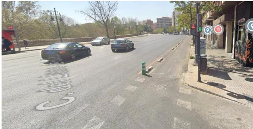
Figura 16 Carril bici sobre la calzada con bordillo
