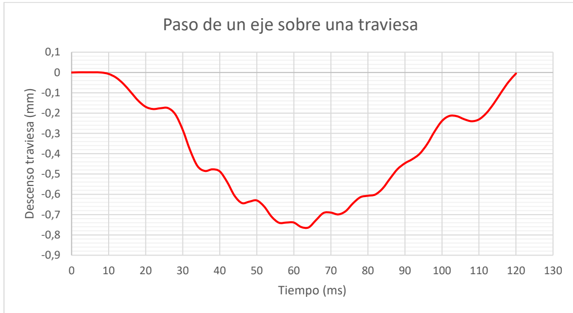
Figura 74. Paso sobre una traviesa de un solo eje con la carga correspondiente a un cercanoías 447 a 120 km/h mayorada por Eisenmann. (Elaboración propia).
