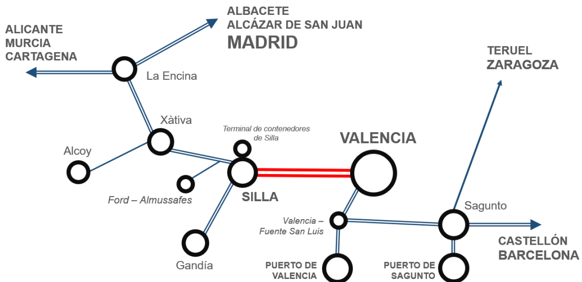
Figura 19. Diagrama de las principales conexiones en ancho ibérico en las que interviene el tramo Valencia – Silla, coloreado en rojo se encuentra el propio tramo objeto del documento. (Elaboración propia).
