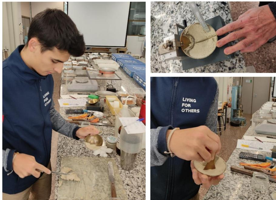
Figura 43 Preparación del ensayo por el método de la cuchara de Casagrande Fuente: elaboración propia.
