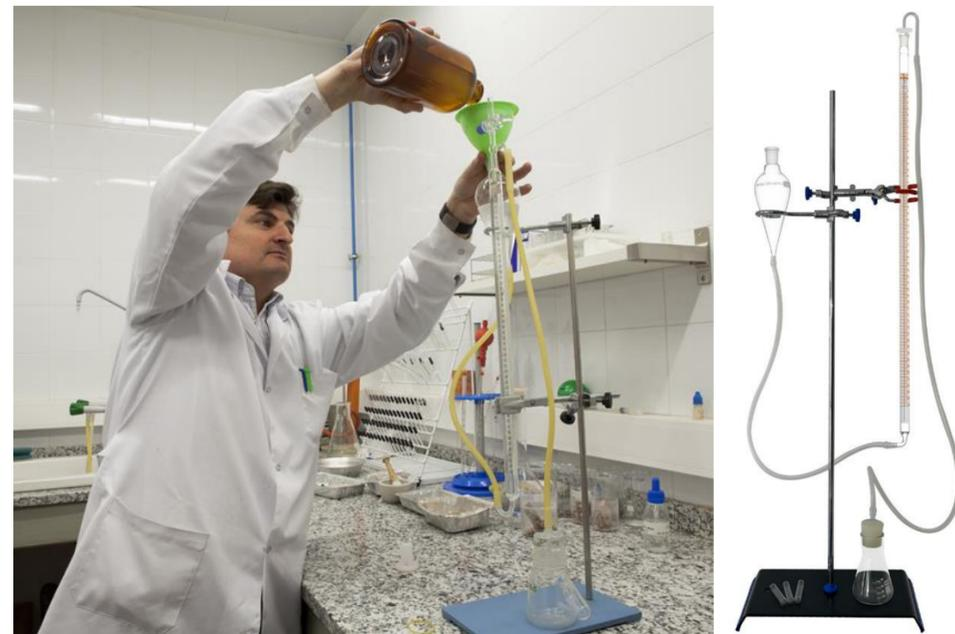
Figura 44 Preparación y material necesario para determinar el contenido de carbonatos Fuente: departamento ingeniería del terreno.
