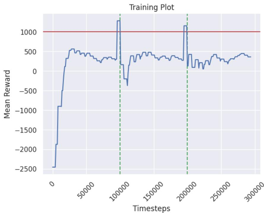
Figura 8.10: Curva de entrenamiento con un size de 31 y 3 tipos de cajas
