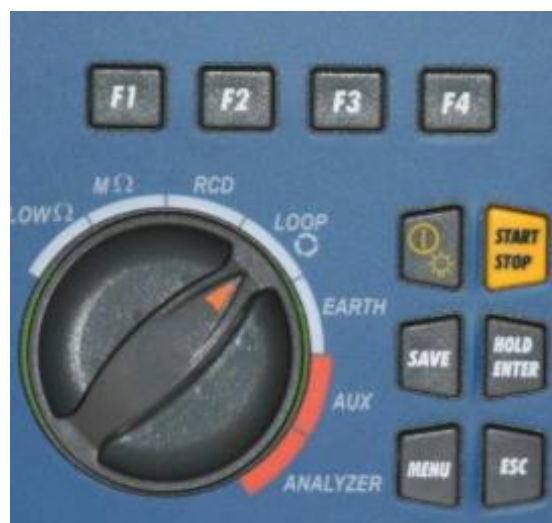
Figura 26: Configuración del comprobador de instalaciones para la prueba de la impedancia.
