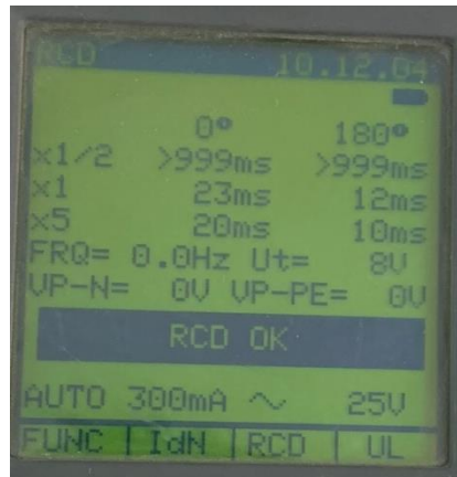
Figura 23: Prueba de diferencial trifásico
