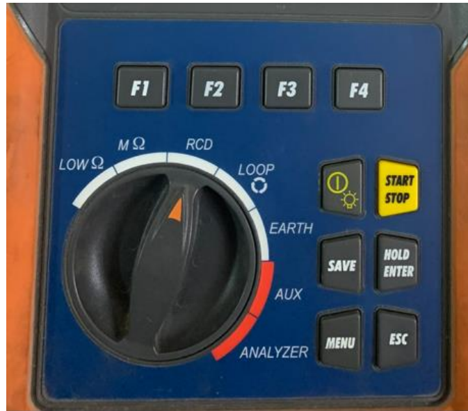
Figura 21: Configuración comprobador de instalaciones para prueba de diferenciales
