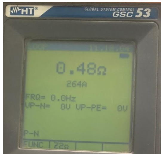
Figura 29: Impedancia de línea P-N
