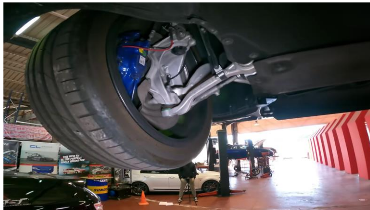
Figura 7: Esquema de suspensión delantera de un BMW 420d Gran Coupé. [22]
