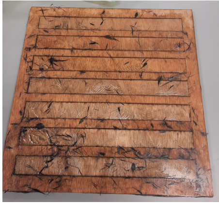
Figura 4.1: Tablero conformador para la fabricación de las probetas
