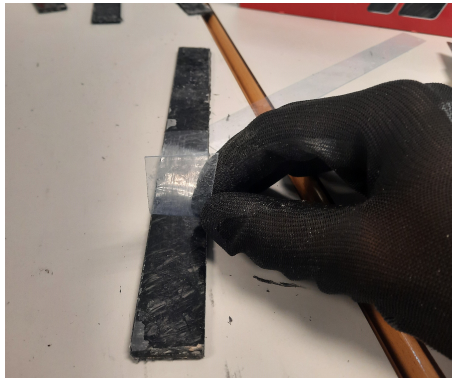
Figura 4.2: Eliminación de la capa de acetato durante el desmoldeo.
