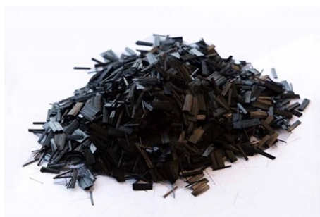
((a)) [4] fibra de carbono tipo chopped.
