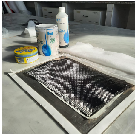
Figura 4.7: Colocación de los distintos elementos a trabajar
