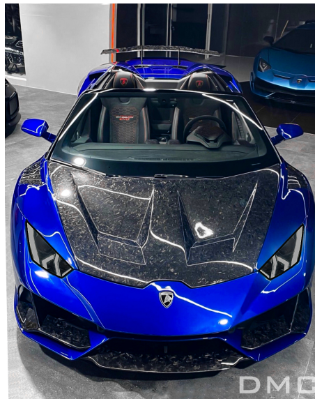
Figura 3.2: [15] Capó de lamborghini fabricado en carbono forjado
