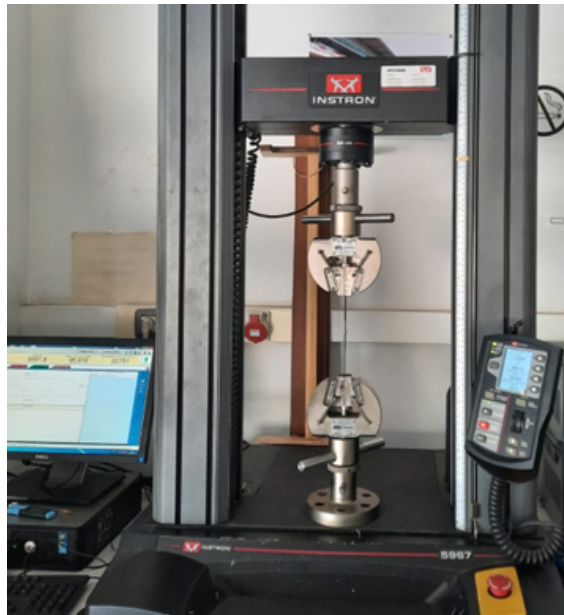
Figura 4.10: Probeta montada sobre máquina de ensayos INSTRON 5967
