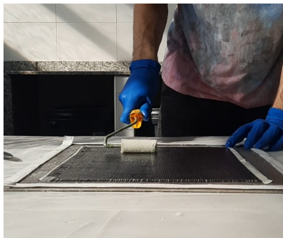
Figura 4.8: Dispersión de la resina epoxy sobre el refuerzo
