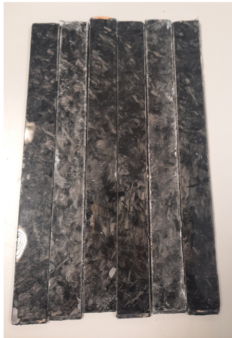
Figura 4.3: Acabado final de las probetas. Se descartó una puesto que la cantidad de epoxy fue insuficiente.
