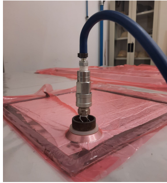
Figura 4.9: Proceso de vacío de la probeta
