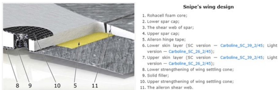
Figura 5.1: Detalle estructura interna F3K Snipe por Vladimir's Model [25]
