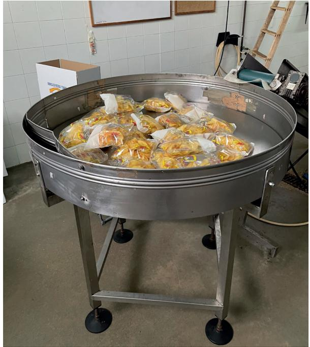
Figura 13. Parte rotatoria de la envasadora
