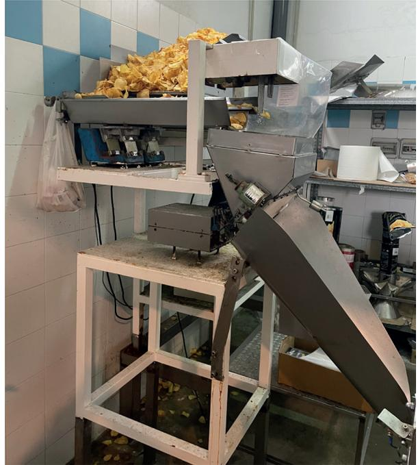
Figura 21. Envasadora manual para bolsas de 1kg
