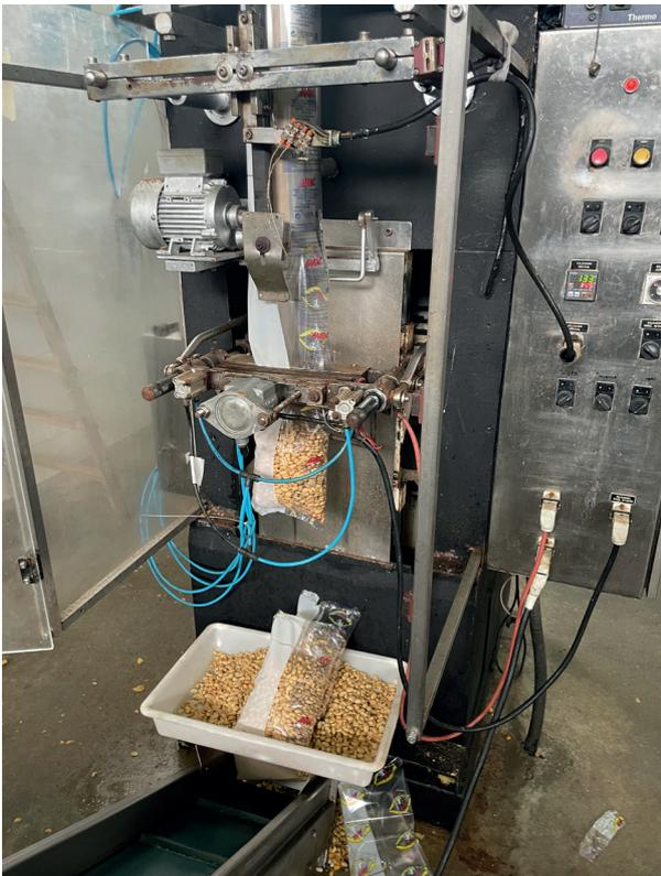
Figura 14. Envasadora. Soldadura del plástico
