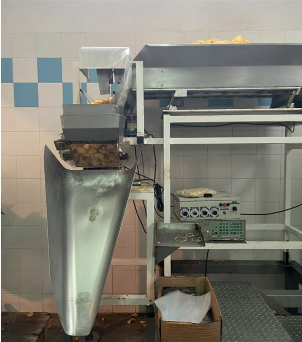
Figura 20. Envasadora manual para bolsas de 1kg
