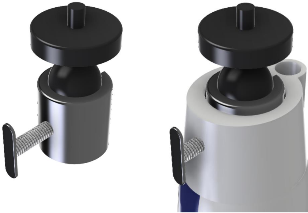
Figura 42. Balljoint y colocación en la prótesis transhumeral. Representación de la simplificación adoptada para los análisis.
