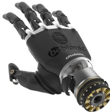
Figura 8. Modelo de prótesis mioeléctrica de mano de Bebionic Hand, Ottobock
